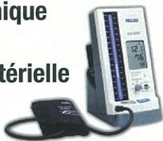
Système électronique permettant au praticien de lire à la fois les valeurs de la pression artérielle sur la colonne digitale au moyen de son stéthoscope et de lire sur l'écran LCD les valeurs mesurées par l'appareil.
