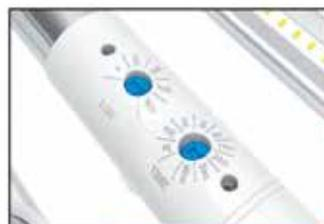
La détection d'un mouvement enclenche automatiquement le tube pour une durée fixée par l'utilisateur (5" à 60"). Passé ce délai les lumières reviennent automatiquement à un niveau défini lors de l'installation (0% à 40%).
